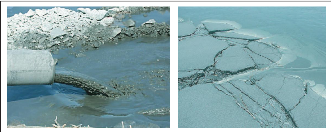
Figure 1.2 Illustration de résidus miniers conventionnels à gauche (boue) et sous forme de pâte à droite
