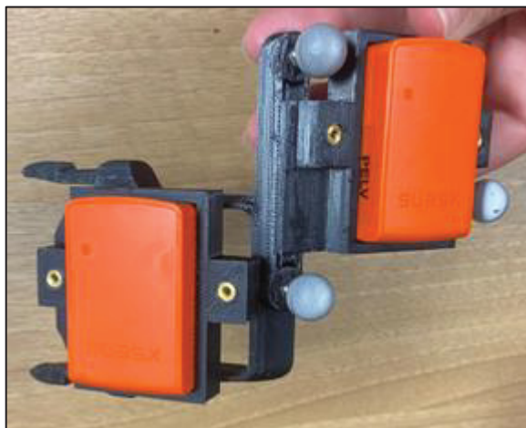
Figure 3.5 Fixations pour MIMUs de la composante fémorale du KneeKG
