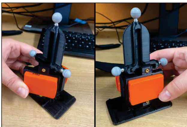
Figure 3.4 Fixations pour MIMUs de la composante sacrale du KneeKG
