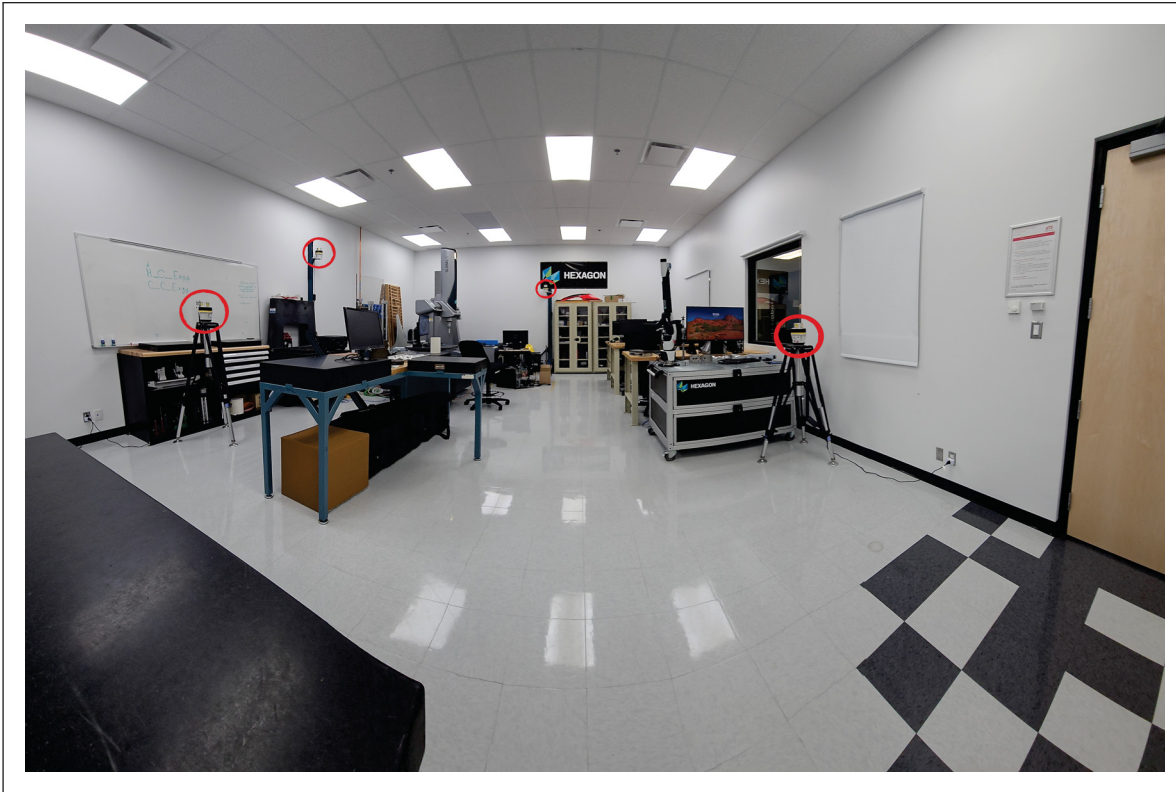
Figure 2.5 Quatre des six émetteurs du système iGPS installés dans le laboratoire de métrologie
