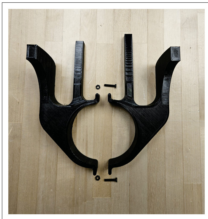
Figure 4.2 Couronne finale adaptée au poignet du bras Kinova
