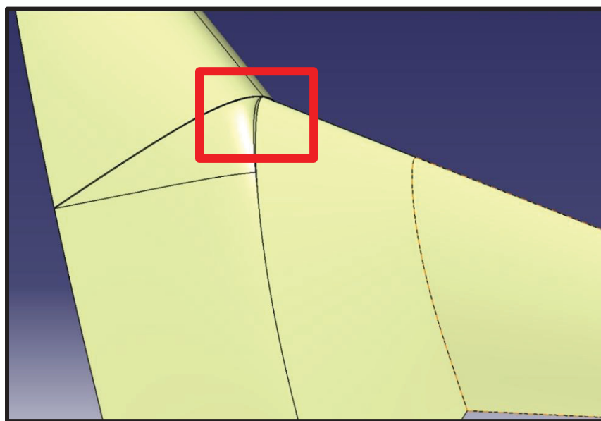
Figure 4.18 Raccord fait à la jonction aile-fuselage
