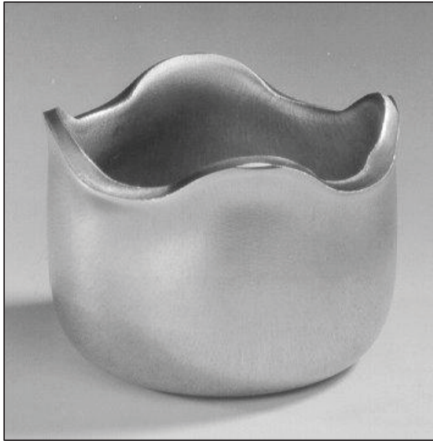
Figure 1.11 Tôle emboutie mettant en évidence quatre oreilles dues à l'anisotropie Tirée de Engler et al.(2006)
