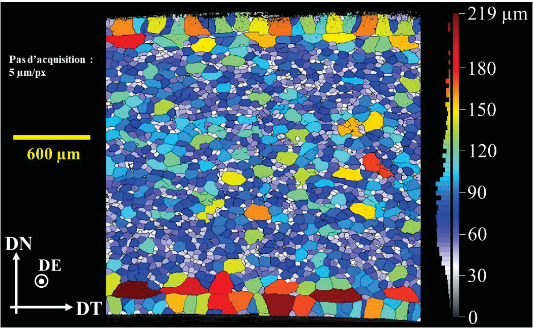
Figure 2.17 Carte des tailles de grains du profilé plat
