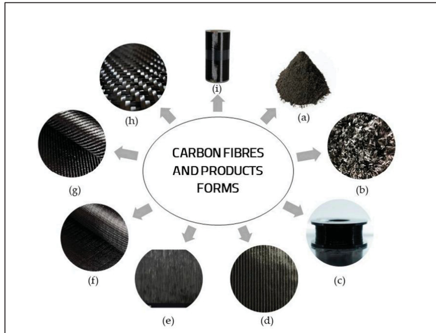
Figure 1.10 Fibres de carbone et formes de produits : (a) fibres broyées, (b) fibres coupées, (c) fibres filamenteuses, (d) fibres biaxiales, (e) fibres unidirectionnelles, (f) tissu à armure toile, (g) tissu à armure sergé, (h) tissu à armure satin, (i) tissu unidirectionnel Tirée de Ursache (2023)
