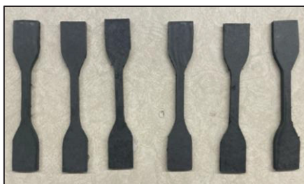
Figure 3.6 Éprouvettes de traction de PK/FLG 2 moulés par compression
