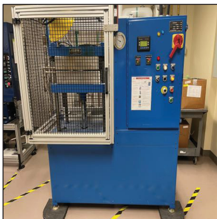
Figure 3.4 Moulage par compression à chaud (Accudyne)
