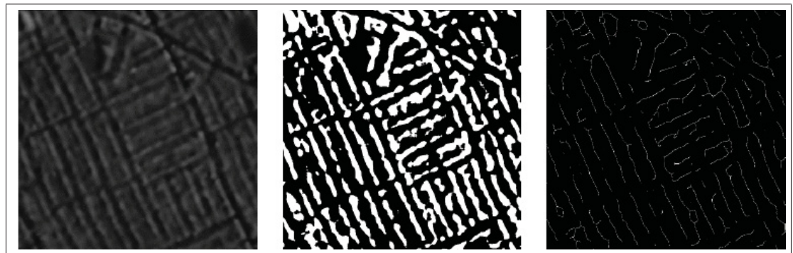
Figure 6.13 De gauche à droite, région d'intérêt de l'image radar de Toronto, (1) Filtrage du bruit de chatoiement par le filtre de Frost avec la taille du noyau 15x15, (2) seuil binaire pour des potentiels routes, (3) résultat donné avec l'application de la squelettisation.
