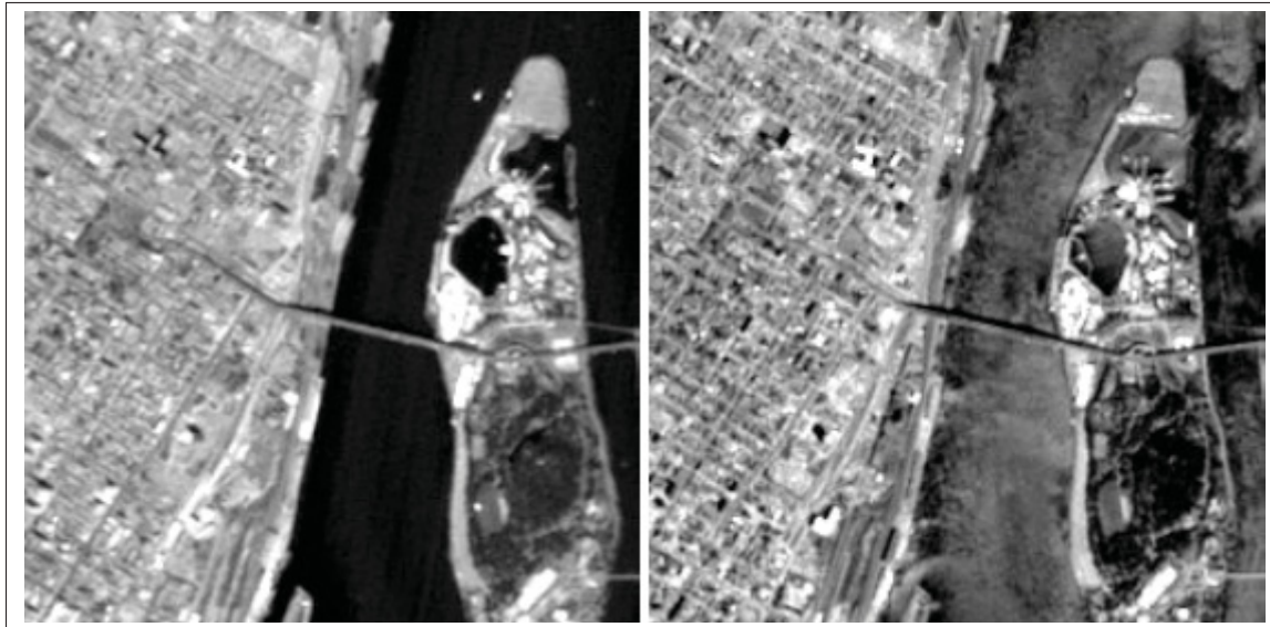
Figure 2.3 Variation du flux selon l'angle d'observation pour une position du soleil presque fixe de deux extraits d'images PAN-version 1 (satellite-SPOT-1) [Image adaptée du module "télédétection numérique" de Cavayas (2008)]
