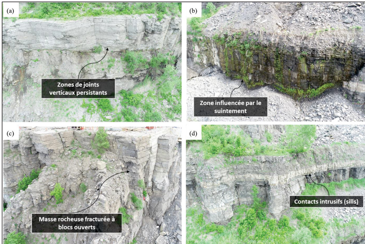
Figure 6.10 Indicateurs topographiques représentatifs de l'instabilité apparente dans la zone B à partir des images RGB. (a) Zones de joints verticaux persistants, illustrant la segmentation structurale de la paroi ; (b) zone influencée par le suintement, caractérisée par des traces d'humidité, des colorations sombres et une végétation localisée ; (c) stratification fracturée, marquée par des surfaces étagées et discontinues le long du litage ; (d) contacts intrusifs sous forme de sills, visibles comme des limites lithologiques continues
