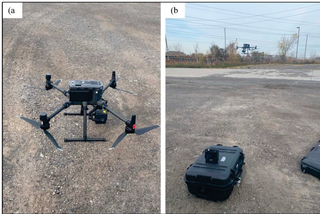
Figure 4.1 Système d'acquisition LiDAR UAV utilisé dans ce mémoire : (a) DJI Matrice 300 RTK équipé du capteur LiDAR Zenmuse L1 ; (b) opération de terrain du même système lors de l'acquisition des données tridimensionnelles à la carrière Francon
