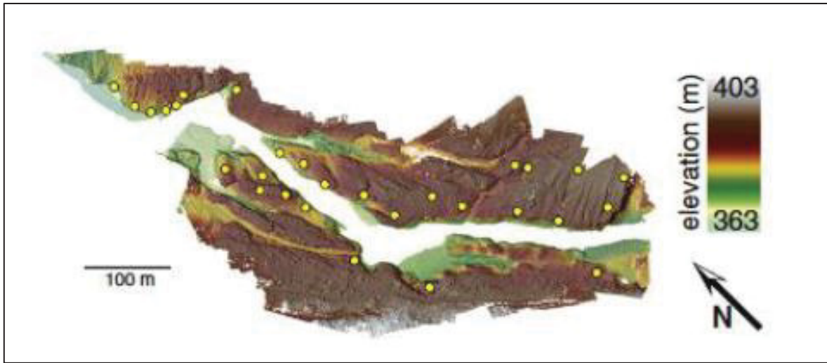
Figure 2.21 Nuage de points obtenu à partir d'un levé UAV pour la modélisation tridimensionnelle de la topographie
