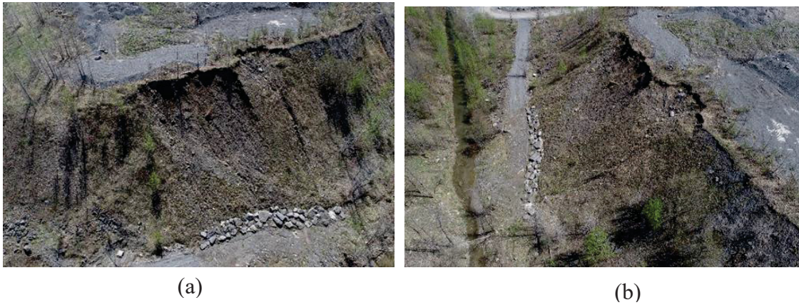
Figure 1.1 Prise de vue aérienne d'une cicatrice de glissement de terrain dans un empilement de remblais granulaires en bordure d'une carrière en opération ( Aubertin et al., 2025)
