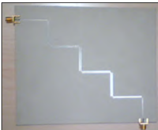
Figure 4.47 Circuit du troisième filtre à résonateurs parallèlement couplés Zigzag.
