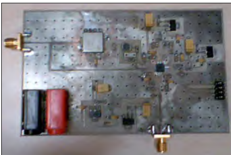
Figure 4.29 Circuit de la boucle à verrouillage de phase.
