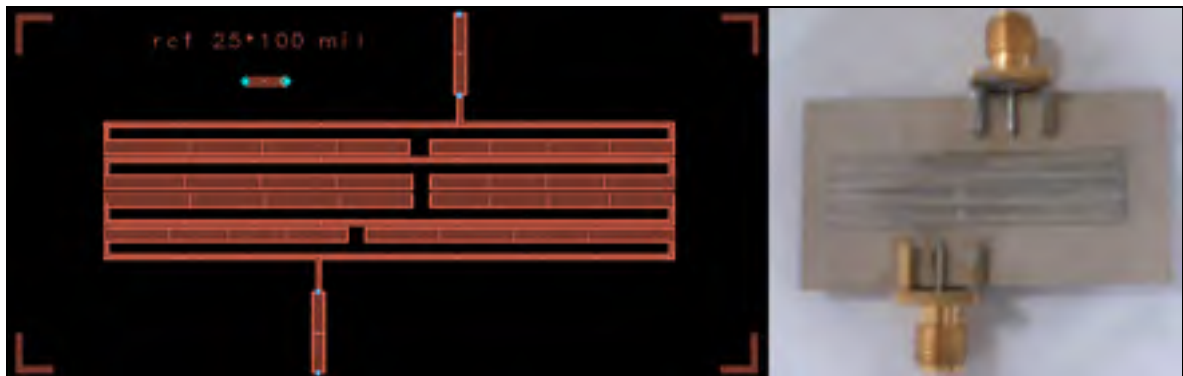
Figure 4.67 Masque (à gauche) et circuit (à droite) du premier filtre miniaturisé.
