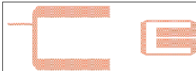
Figure 4.50 Résonateur hairpin à impédance renforcé (à gauche) et résonateur hairpin miniaturisé (à droite).
