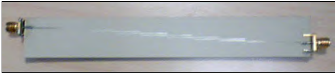
Figure 4.61 Circuit du sixième filtre à résonateurs parallèlement couplés.
