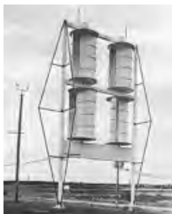
Figure 4 Éolienne à trainée de type Savonius [9]
