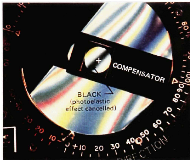
Figure 75 Manipulation du polariscope avec le compensateur (Adapté de Photolastic Division measurement group, Inc., 1992)
