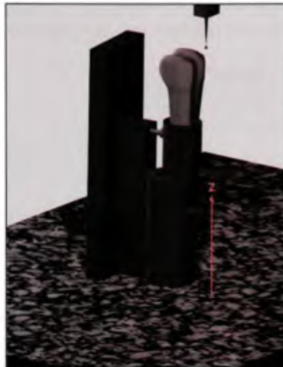
Figure 4.14 Gabarit de positionnement sur le marbre d'une MMT standard.
