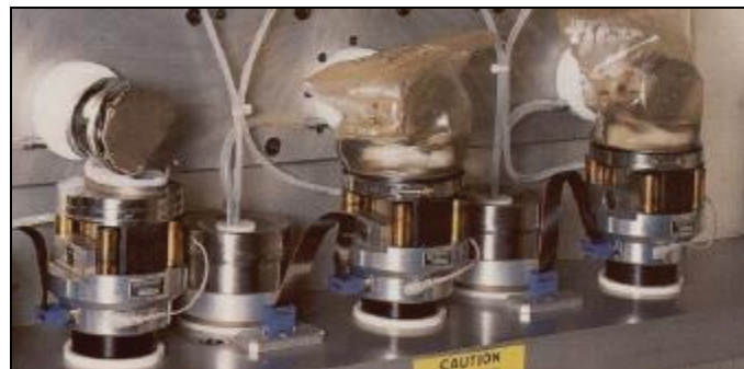
Figure 1.28 Environnement du "AMTI-Boston 6-station knee simulator" Tirée de (Zhao, Sakoda et al. 2008)
