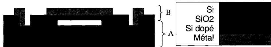
Figure 28 Premier procédé de fabrication du capteur de pression
