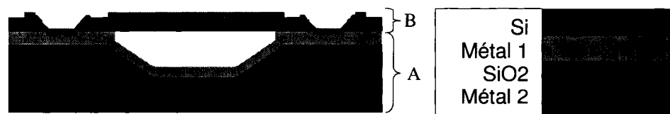
Figure 29 Deuxième procédé de fabrication du capteur de pression
