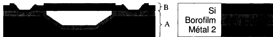
Figure 30 Troisième procédé de fabrication du capteur de pression
