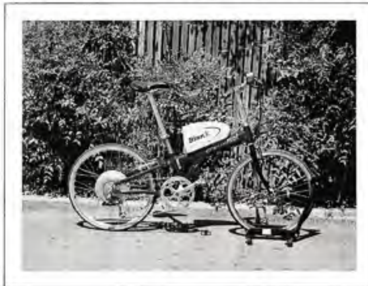
Figure 0.1 Système BionX installé sur une bicyclette
