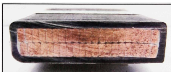
Figure 1.2 L'isolation thermodurcissable pour une barre d'alternateur.
