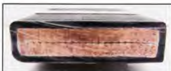
Figure 1.2 L'isolation thermodurcissable pour une barre d'alternateur.
