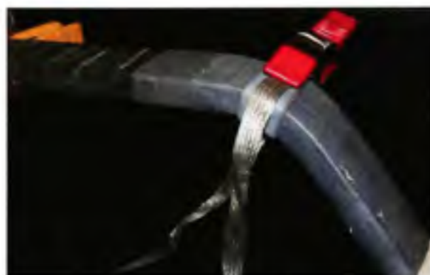
Figure 4.19 Branchement d'une électrode de garde.
