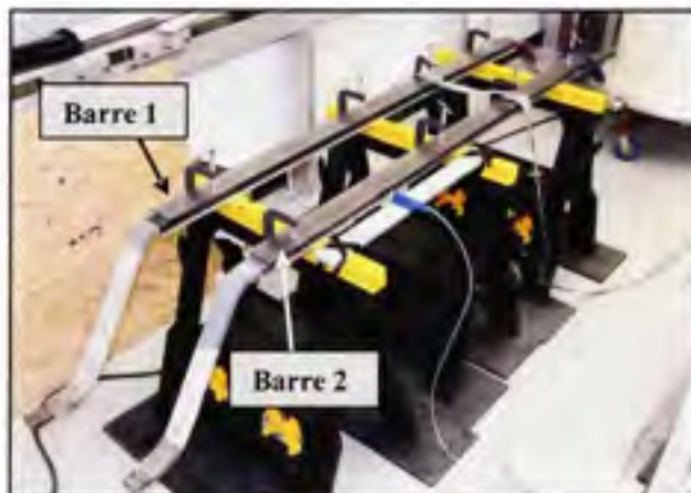
Figure 3.5 Les barres identifiées 1 et 2 pour le vieillissement électrique.
