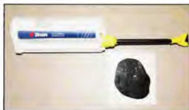
Figure 4.27 Le mélange à deux éléments de silicone caoutchoutée.
