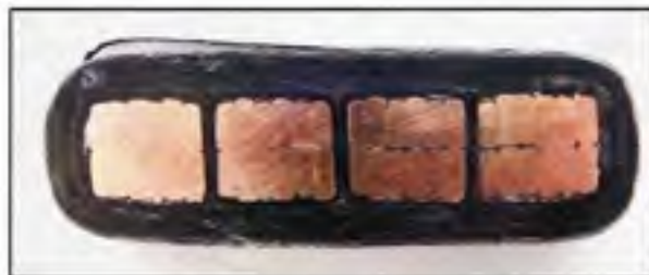
Figure 1.1 L'isolation thermoplastique d'une bobine d'alternateur.
