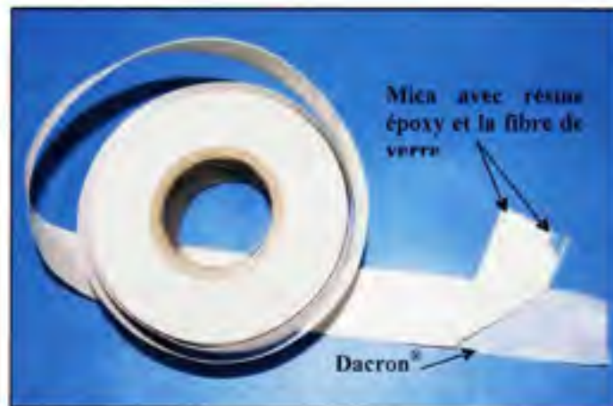
Figure 1.3 Le ruban utilisé pour l'isolation de type thermodurcissable.
