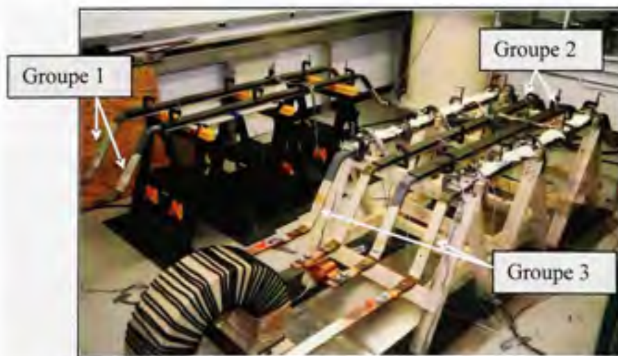
Figure 3.1 Le montage expérimental complet utilisé pour le vieillissement des barres.
