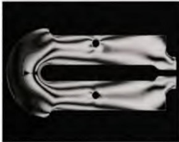
**Figure 2.6 Exemple d'analyse avec la méthode photoélastique.**
