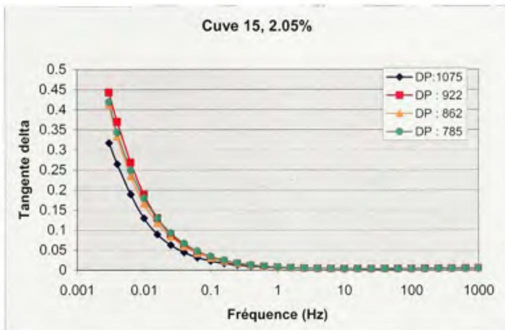
**Figure 5.6** Variation des pertes en fonction de la fréquence pour une cuve contenant de l'huile Luminol Tri à différentes étapes du vieillissement.
