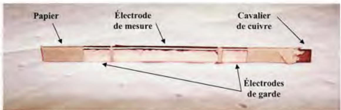
**Figure 6.1** *Échantillon sur cavalier de papier non-imprégné avec électrodes de cuivre.*
