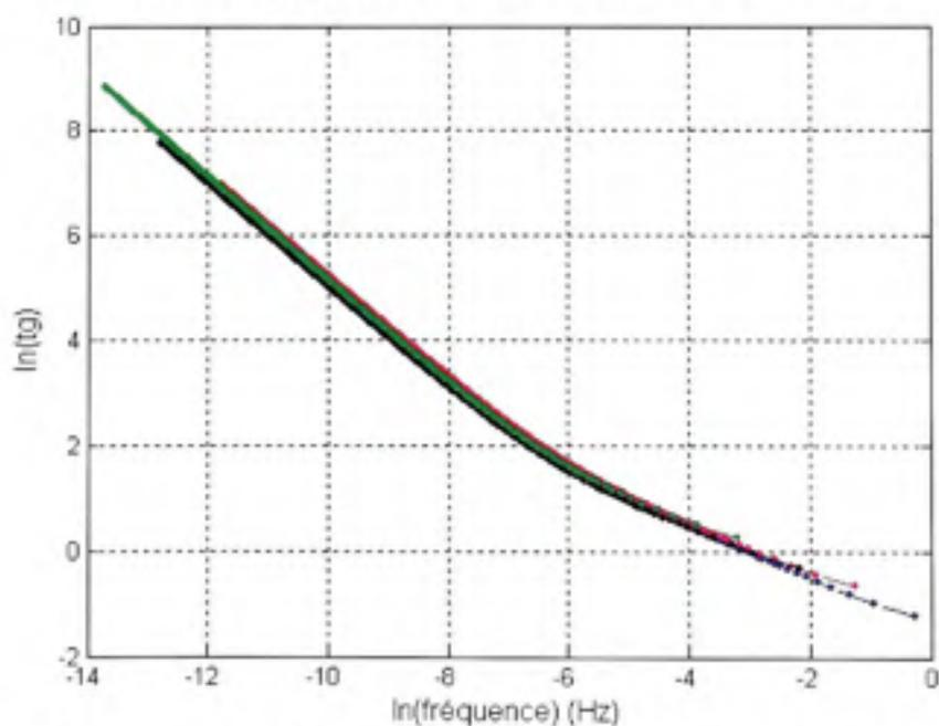
**Figure 5.32** Normalisation des courbes en température à 25°C à l'aide de la modélisation pour les courbes de la Figure 5.26.
