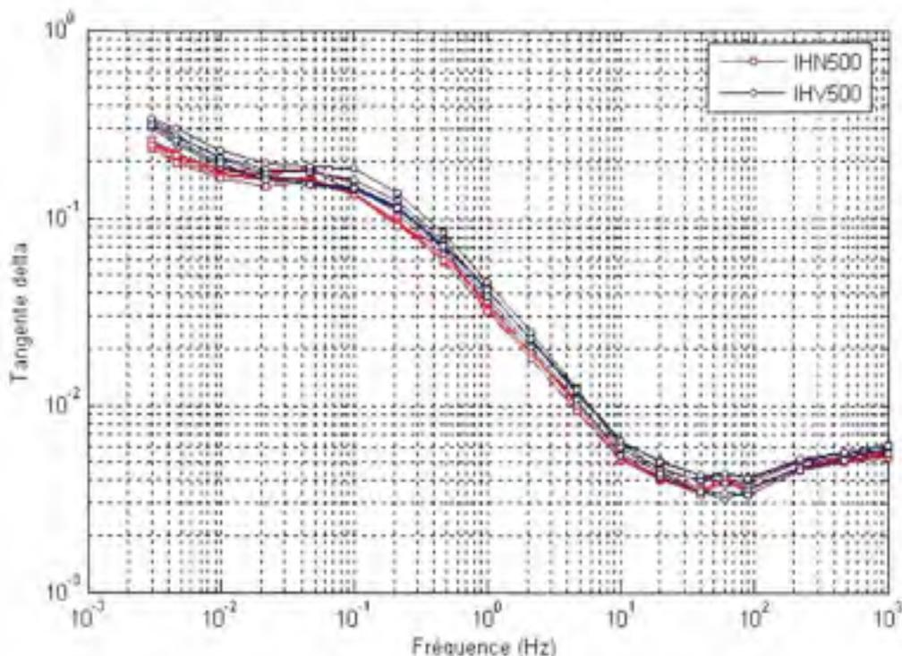
**Figure 6.10** *Échantillons imprégnés d'huile neuve et d'huile vieillie pour la mesure à 500 DP.*
