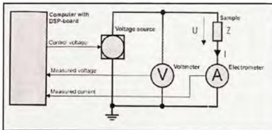
Figure 4.4 *Mesure de l'impédance d'un système d'isolation par l'appareil IDA 200.*
