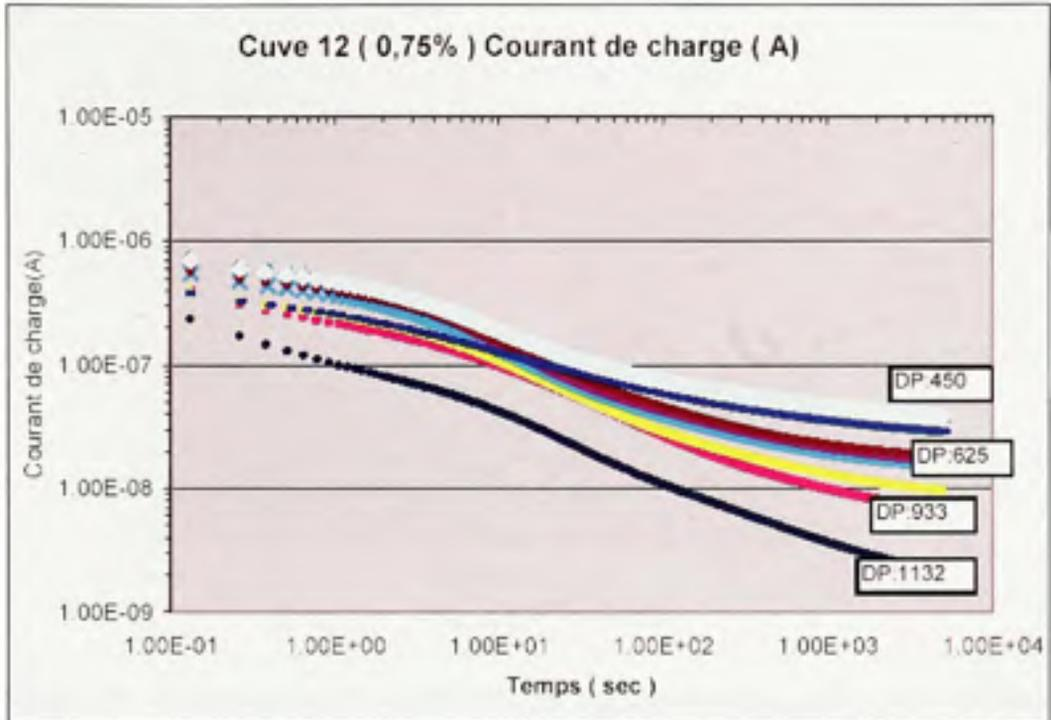
**Figure 5.7** Variation du courant de polarisation en fonction du temps pour une cuve sèche.
