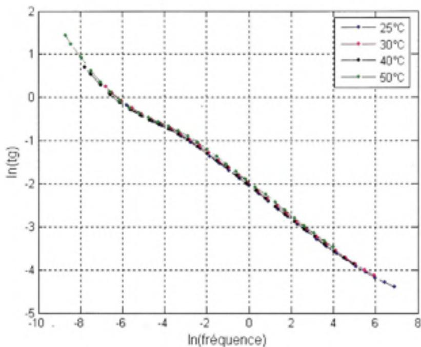
**Figure 5.30** Normalisation des courbes en température à 25°C à l'aide de la modélisation pour les courbes de la Figure 5.24.
