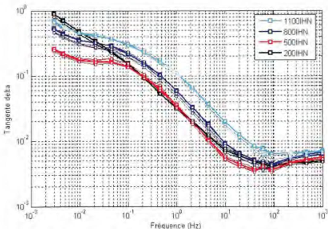
Figure 6.7 *Échantillons imprégnés d'huile neuve, mesures après vieillissement.*
