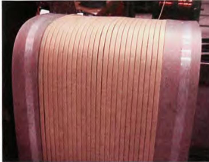
**Figure 1.1** *Enroulement utilisé dans une maquette de transformateur.*
