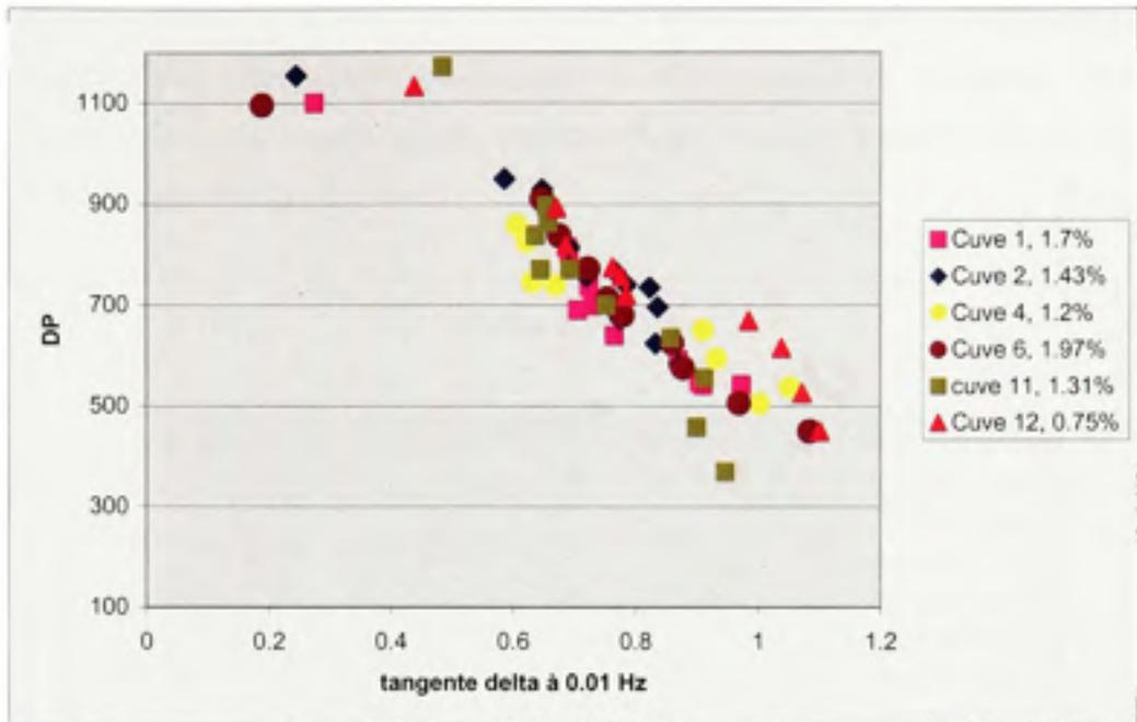
Figure 5.3 Corrélation entre le DP et la  $\tan \delta$  à 0.01 Hz pour les cuves sèches des groupes 1, 2 et 4.
