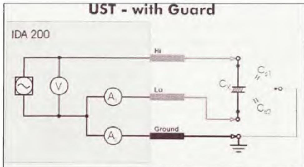
Figure 4.6 Schéma de connexion d'une mesure UST avec garde.
