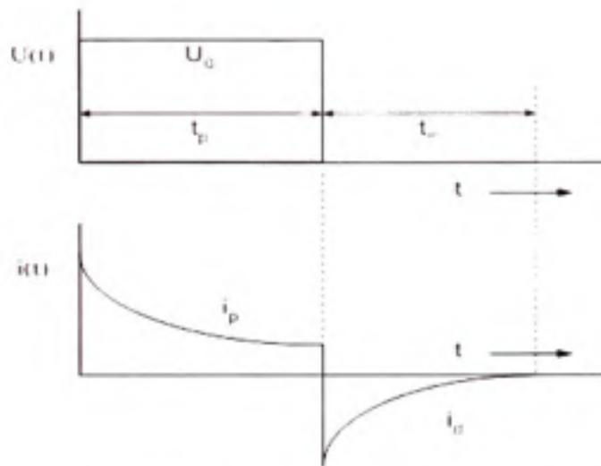
**Figure 4.1** *Principe de la mesure des courants de polarisation et dépolarisation.*
