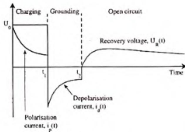
Figure 4.2 *Principe de la mesure de la tension de retour.*
