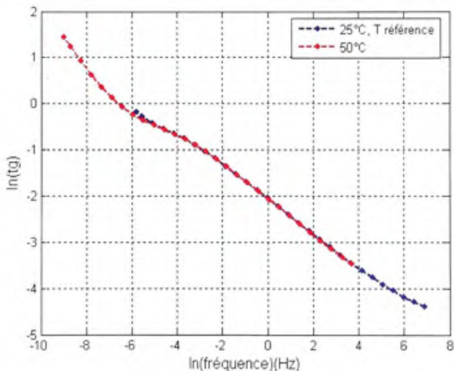
**Figure 5.23** Déplacement en fréquence d'une courbe à 50°C vers la courbe maîtresse à 25°C.
