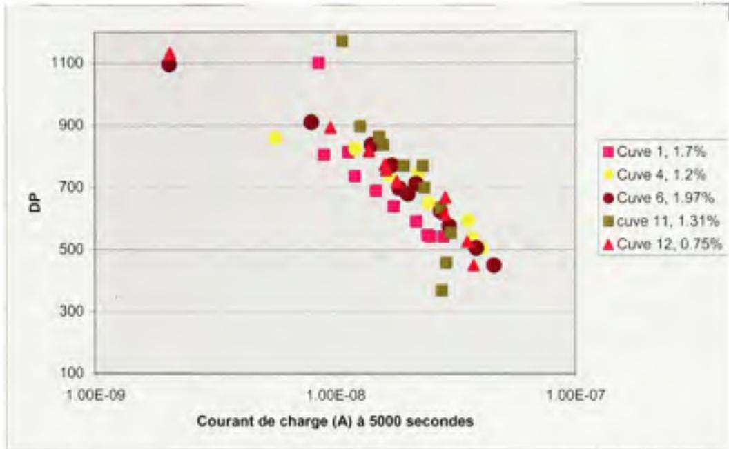
**Figure 5.9** Graphique du DP en fonction du courant de polarisation pour les cuves sèches des groupes 1 et 4.
