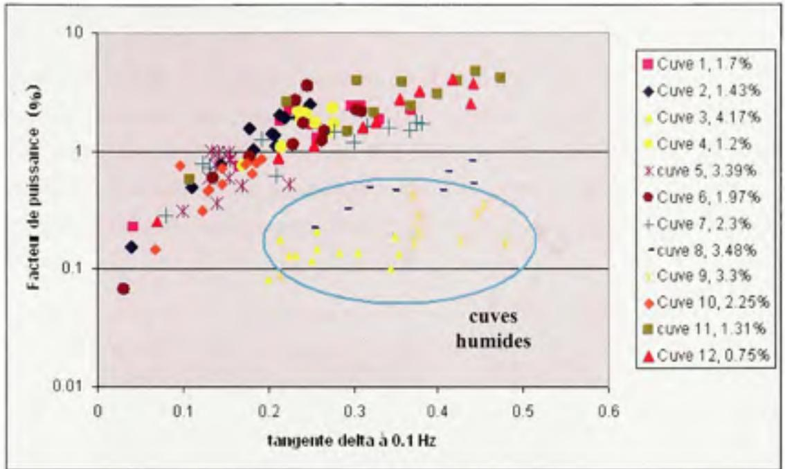
Figure 5.11 Graphique du FP en fonction de la  $\tan \delta$  pour les cuves des groupes 1, 2 et 4 à 0.1 Hz.
