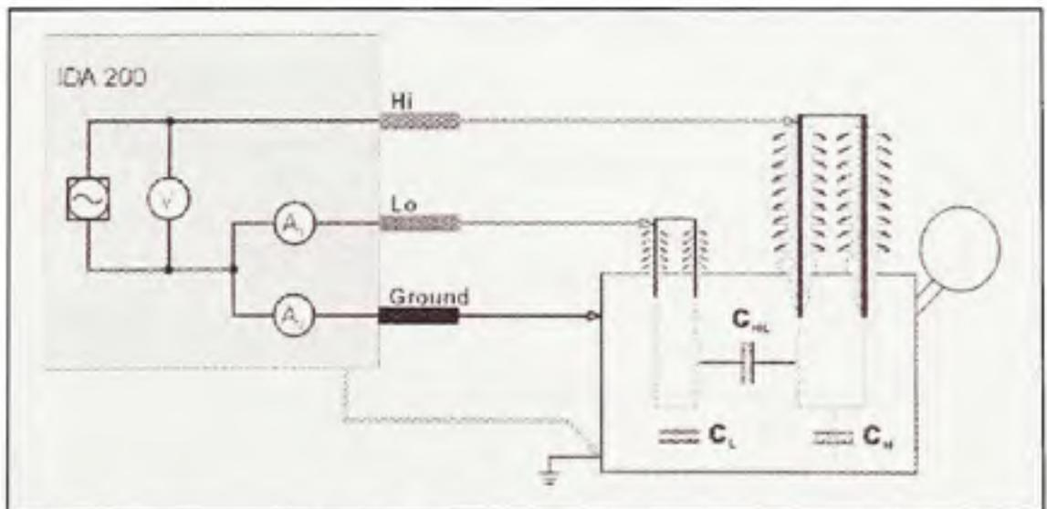
**Figure 4.5** Connexion du IDA 200 d'un transformateur à deux enroulements avec une mesure entre les enroulements haute et basse tension.
