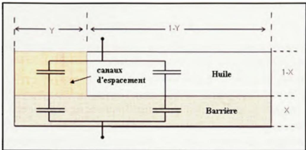
Figure 4.9 *Modèle XY de l'isolation des transformateurs.*
