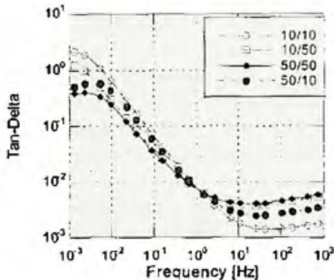
**Figure 4.10** Influence des paramètres géométriques X et Y sur la tangente delta d'un transformateur de puissance avec le rapport X/Y = 10/10, 10/50, 50/50 et 50/10.
