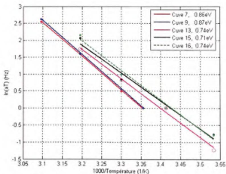
Figure 5.34 Graphique d'Arrhenius des cuves 1, 7, 8, 15 et 26.
