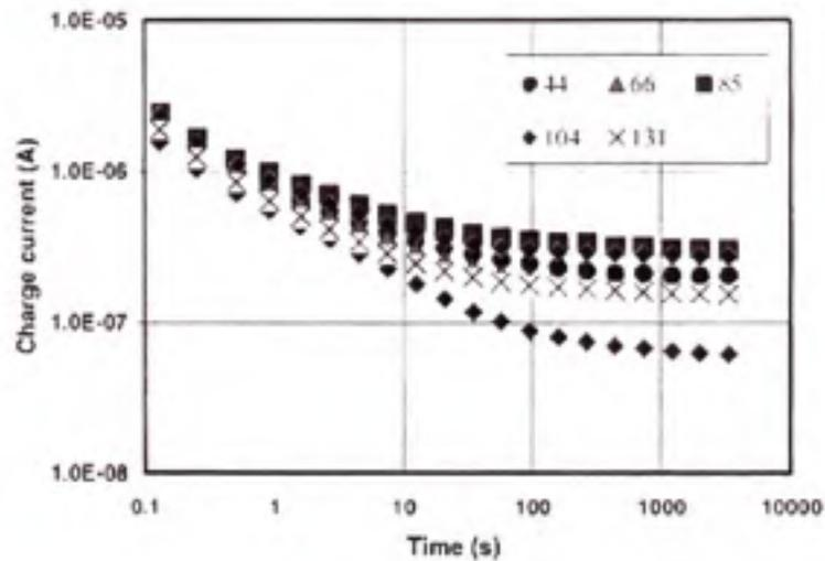
**Figure 4.14** *Courant de polarisation de l'isolation de maquettes de transformateur à un taux d'humidité de 3,48%.*
