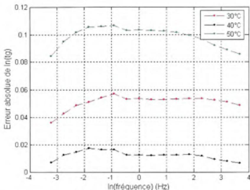
**Figure 5.31** Erreur absolue mesurée entre la courbe maîtresse et chaque courbe normalisée en fonction de la fréquence pour la modélisation des courbes de la Figure 5.30.
