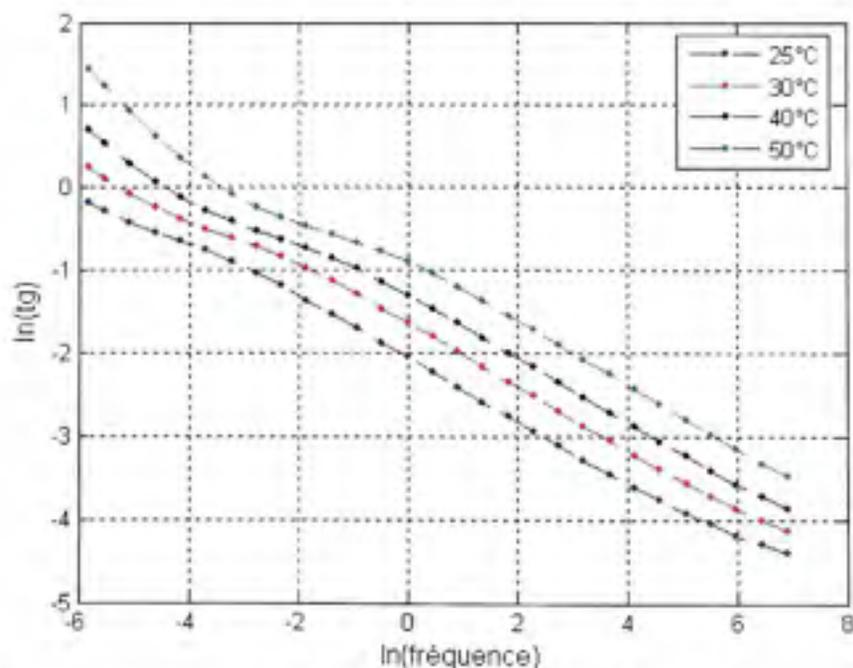
**Figure 5.24** Courbes de la tangente delta prises à différentes températures pour la cuve 9.
