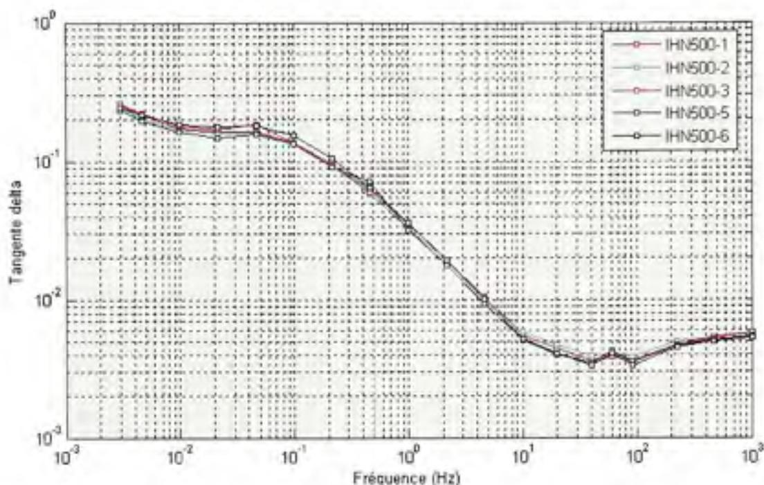
Figure 6.6 *Reproductibilité des mesures sur cinq échantillons imprégnés d'huile neuve à 500 DP.*
