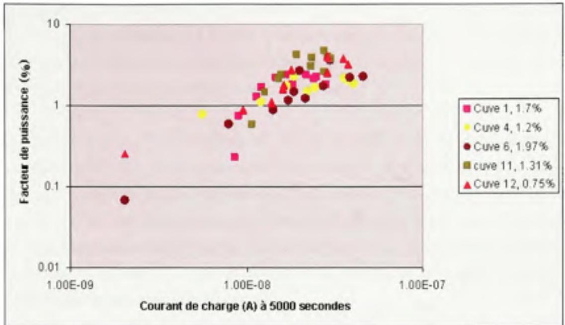
**Figure 5.14** *FP en fonction du courant de charge à 5000 secondes pour les cuves sèches des groupes 1 et 4 (taux d'humidité de moins de 2%).*
