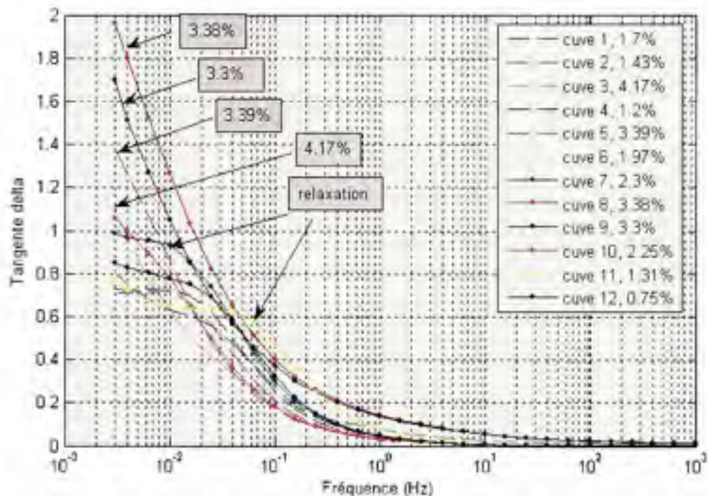
**Figure 5.18** Tangente delta mesurée pour les cuves 1 à 12, pour un DP de 750.
