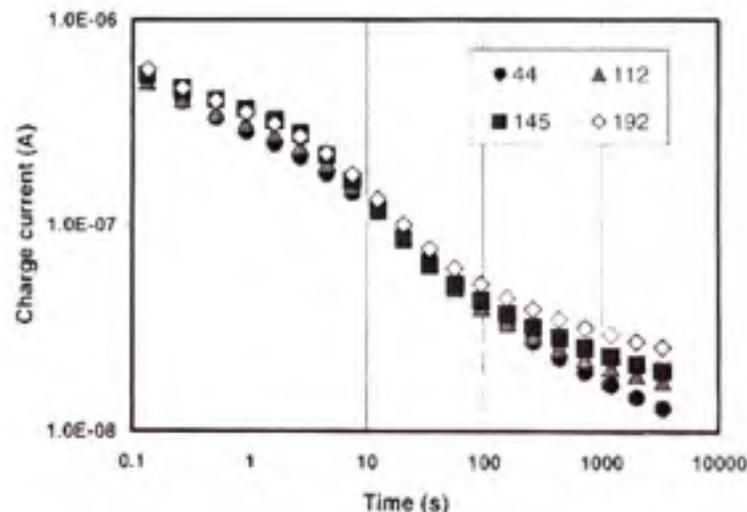
**Figure 4.13** Courant de polarisation de l'isolation d'une maquette de transformateur à 1.2% d'humidité. (les chiffres représentent le nombre d'heures de vieillissement).
