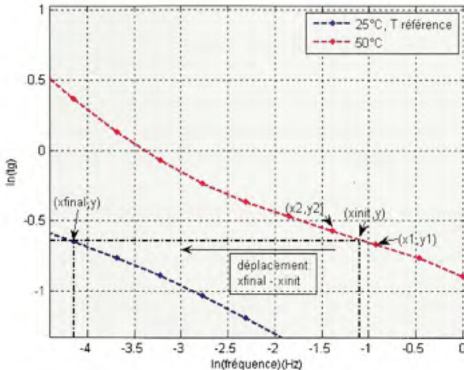
Figure 5.22 *Déplacement horizontal par interpolation d'une courbe en température.*
