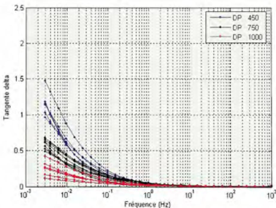
Figure 5.21 *Comparaison de la modélisation de la tangente delta du papier imprégné pour des DP de 450, 750 et 1000.*
