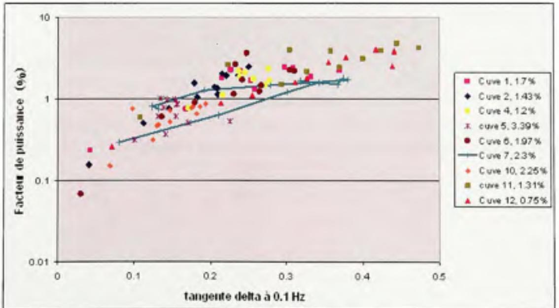
Figure 5.12 Graphique du FP en fonction de la  $\tan \delta$  pour les cuves sèches des groupes 1, 2 et 4 à 0.1 Hz.
