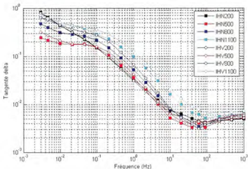
Figure 6.11 *Comparaison des échantillons imprégnés d'huile neuve et vieillie pour tous les DP à partir d'une mesure moyenne.*
