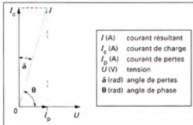
**Figure 3.3** *Diagramme de Fresnel pour un condensateur contenant un diélectrique imparfait.*
