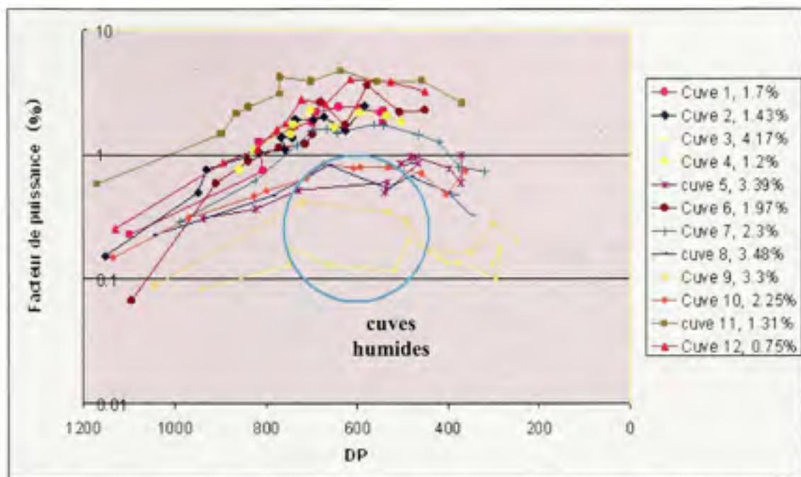
**Figure 5.10** *Facteur de puissance de l'huile en fonction du DP du papier.*
