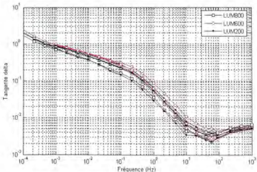
Figure 6.13 Échantillons de papier imprégnés d'huile Luminol Tri.
