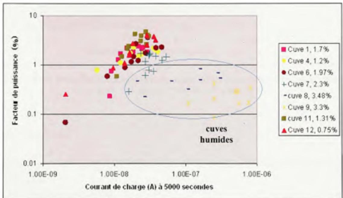
Figure 5.13 FP en fonction du courant de charge à 5000 secondes pour les cuves des groupes 1 et 4.
