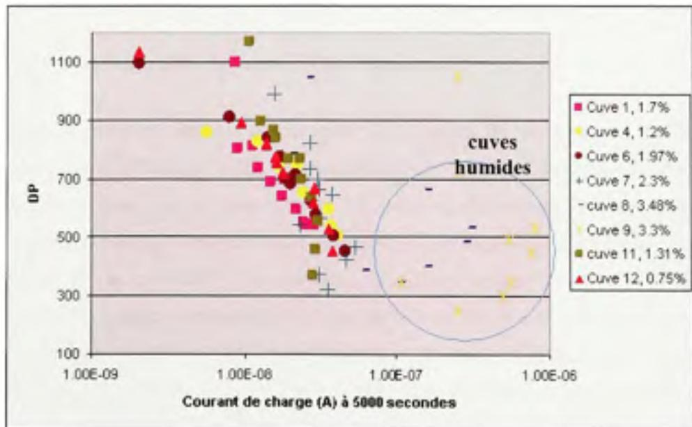
**Figure 5.8** Graphique du DP en fonction du courant de polarisation pour les cuves des groupes 1 et 4
