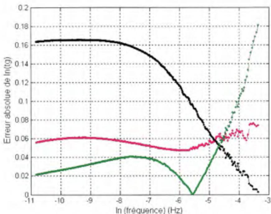
**Figure 5.33** Erreur absolue mesurée entre la courbe maîtresse et chaque courbe normalisée en fonction de la fréquence pour la modélisation des courbes de la Figure 5.32.
