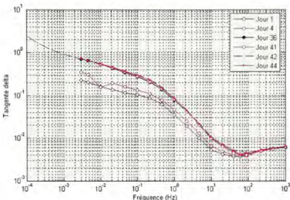
**Figure 6.5** Conditionnement d'un échantillon d'huile Luminol à 600DP après vieillissement.
