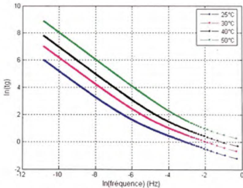
Figure 5.26 Courbes des courants de polarisation convertis dans le domaine des fréquences à différentes températures pour la cuve 9.
