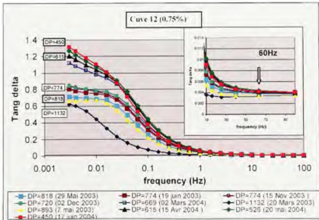
**Figure 5.2** Variation typique des pertes en fonction de la fréquence pour une cuve sèche durant le vieillissement.
