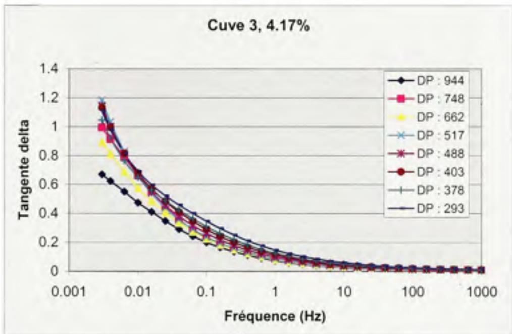
**Figure 5.5** Variation des pertes en fonction de la fréquence pour une cuve humide, à différentes étapes du vieillissement.
