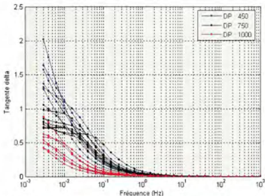
Figure 5.20 *Comparaison de la tangente delta des cuves pour des DP de 450, 750 et 1000.*
