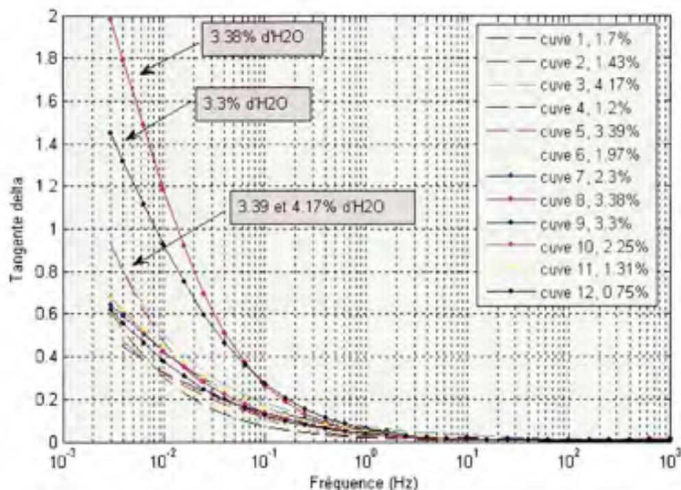
Figure 5.19 Modélisation de la tangente delta du papier pour les cuves 1 à 12, avec un DP de 750.
