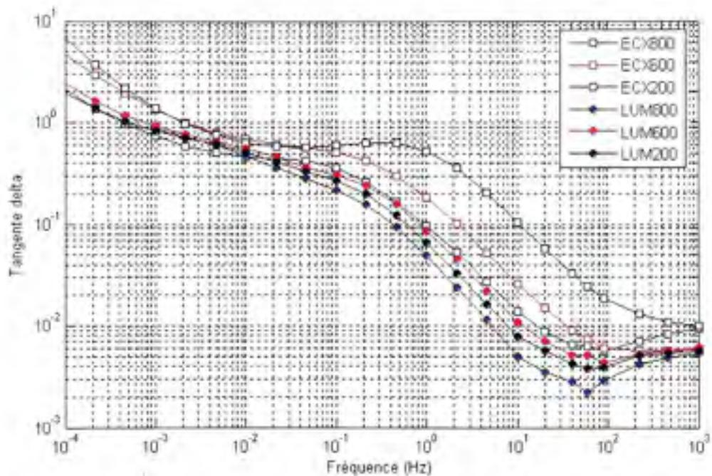
Figure 6.14 Comparaison entre les échantillons imprégnés d'huile Luminol et Nitro 10CX.
