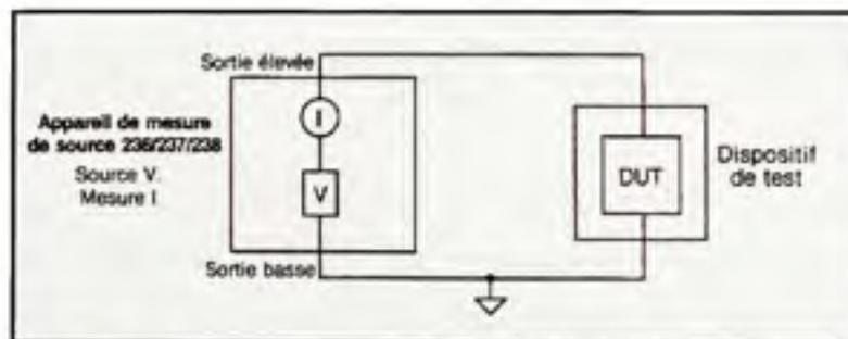
Figure 4.7 Principe de la mesure d'un diélectrique par l'appareil Keithley 237.
