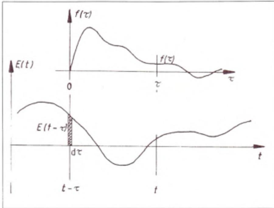
**Figure 3.2** Principe de la polarisation en fonction du temps.
