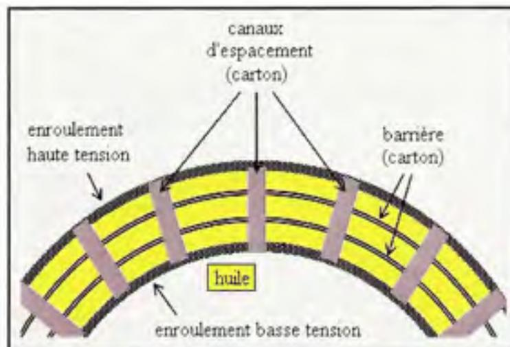
**Figure 4.8** Section de l'isolation papier/huile entre les enroulements haute et basse tension.
