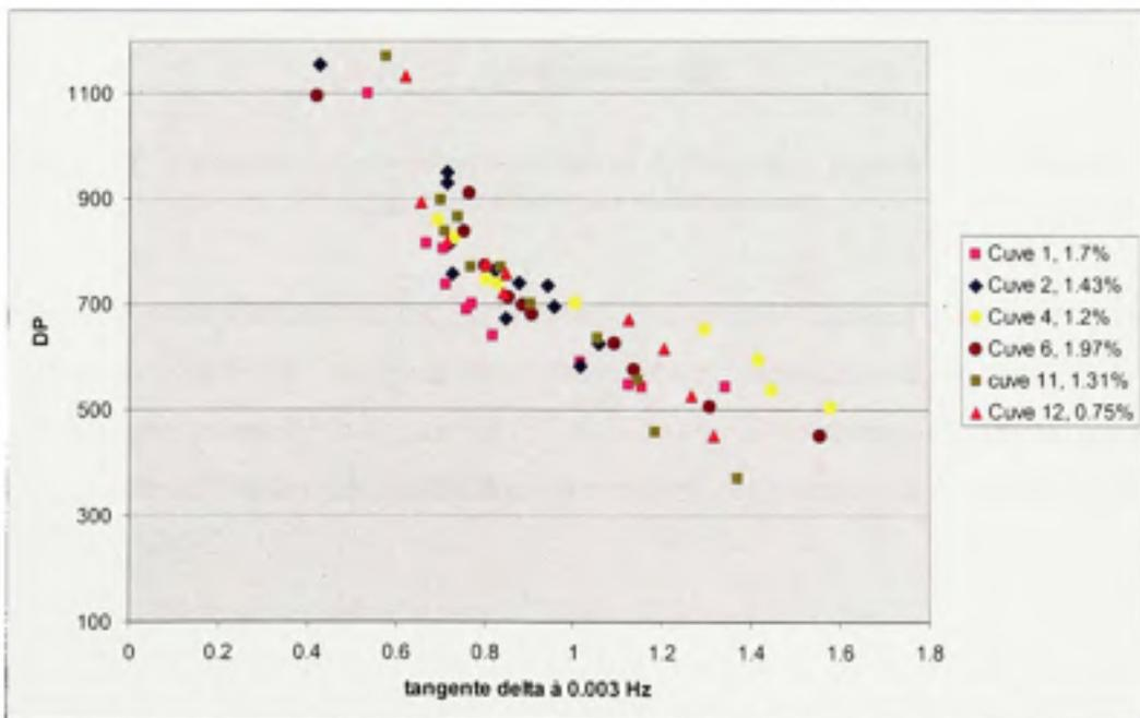
Figure 5.4 Corrélation entre le DP et la  $\tan \delta$  à 0.003 Hz pour les cuves sèches des groupes 1, 2 et 4.
