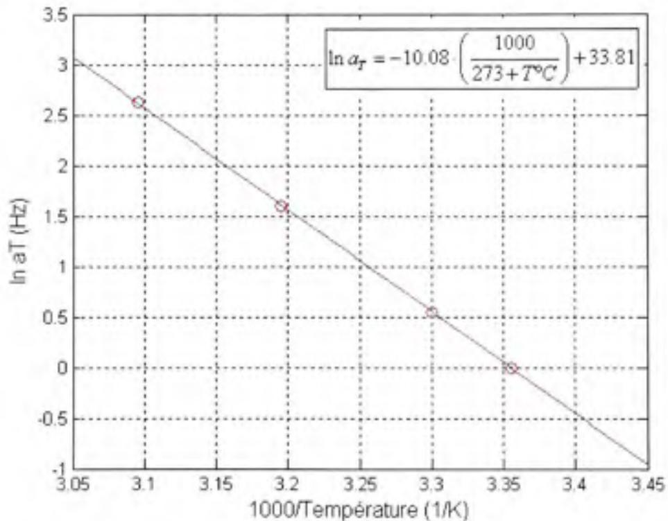
**Figure 5.29** Déplacement en fonction de  $1000/Température$  la cuve 9, mesure prises avec l'appareil IDA 200.
