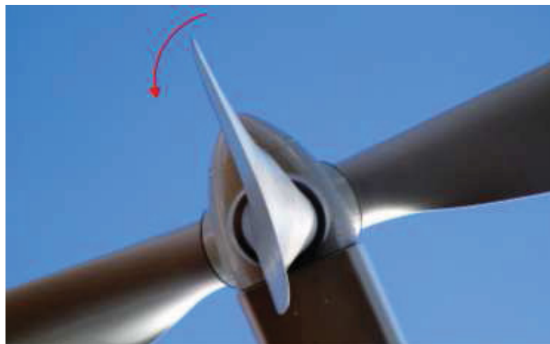
Figure 3.5 Système de variation de l'angle de calage des pales.
