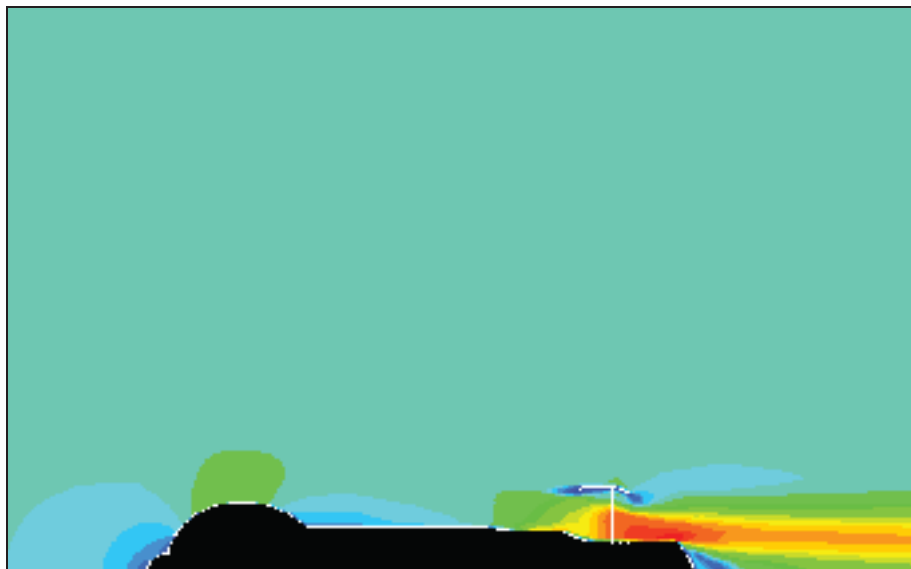
Figure 6.6 L'écoulement autour de la nacelle pour un rotor en arrêt, modèle k-\varepsilon standard, K=25 .
