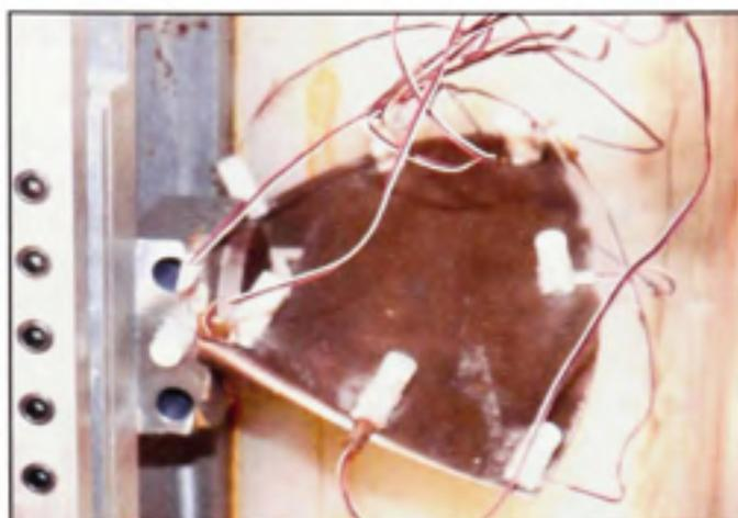
Figure 2.17 Essais modaux de l'aube dans l'air.
