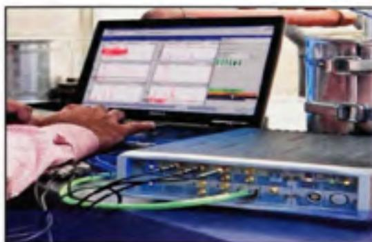
Figure 2.6 Système d'acquisition LMS.
