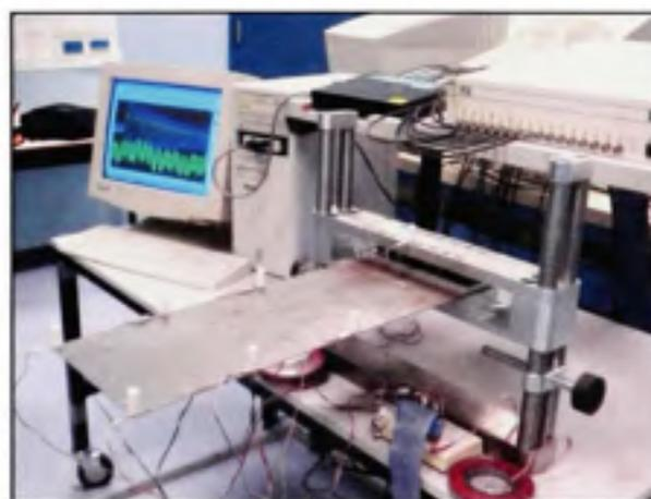
Figure 2.12 Essai d'une plaque encadrée dans l'air.
