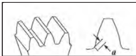
Figure 1.13 Fissure en pied de dent.
