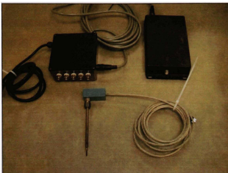
Figure 3.6 Capteur de température et boîtier de traitement Nexum Research Corporation.
