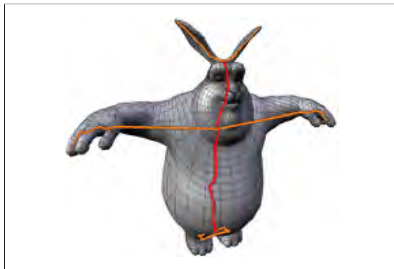
Figure 3.2 Graphe topologique extrait de Buck, le lapin du court métrage Big Buck Bunny (2008).
