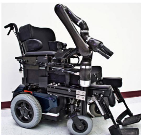
Figure 1.2 Le bras manipulateur JACO.
