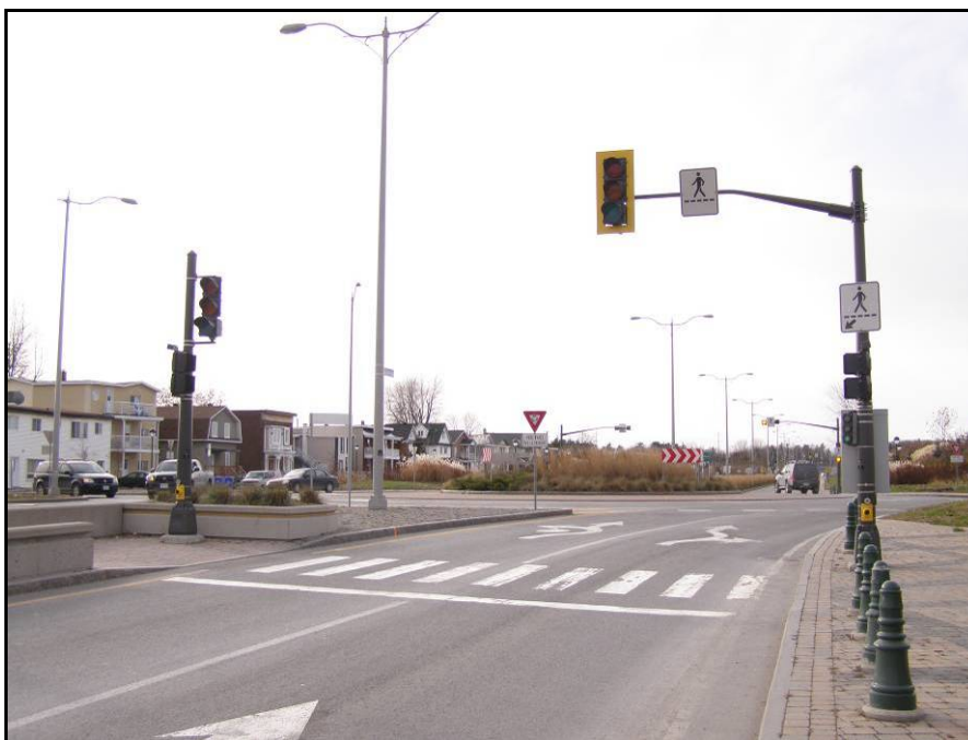
Figure 3.3 Aménagement d'un feu sur appel exclusif pour piétons en approche, giratoire de Gatineau 2 (2008).
