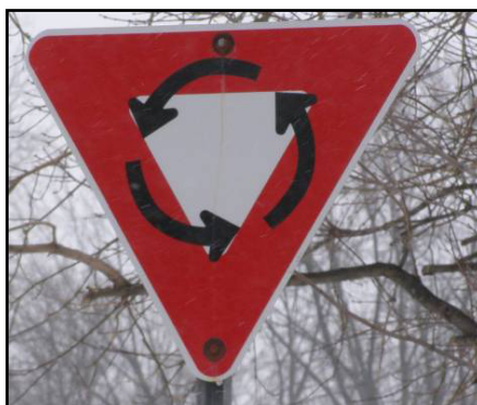
Figure 3.29 Symbole de flèches inapproprié, giratoire de Chicoutimi 2 (2008).
