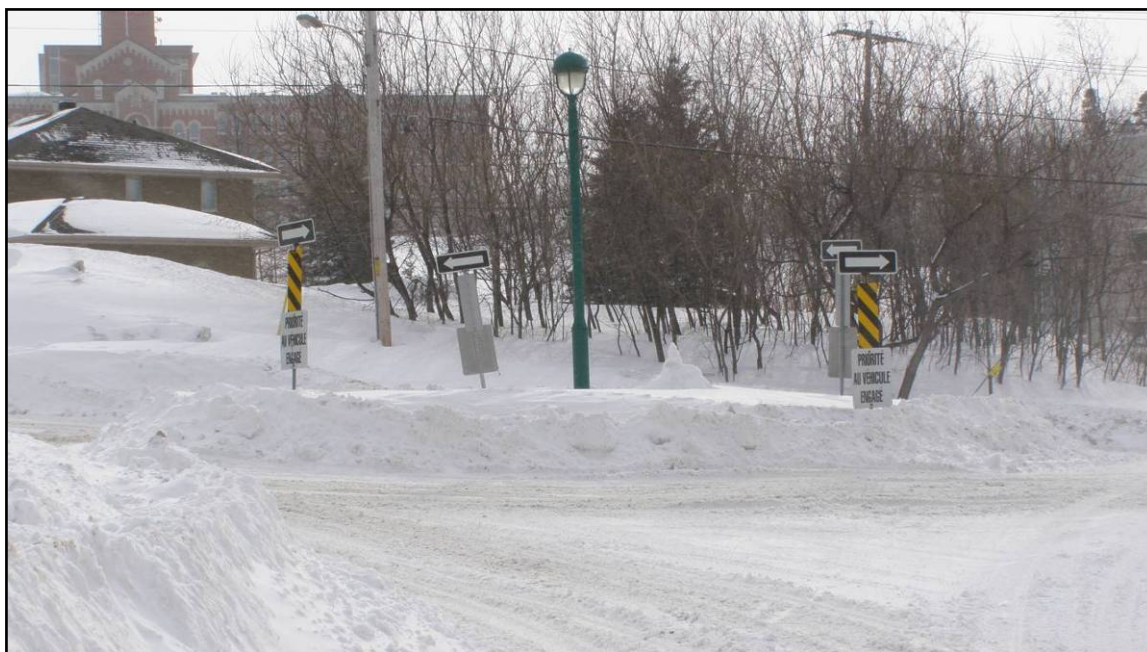
Figure 3.50 Confusion causée par le panneau « Sens unique », giratoire de Chicoutimi 2 (2008).
