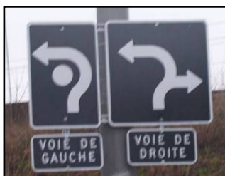
Figure 3.34 Panneau « Direction de voies », giratoire du bout-de-l'île de Montréal (2006).
