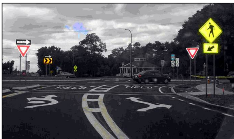
Figure 1.23 Exemple d'application du marquage de flèches de sélection de voies aux États-Unis. Tirée de Woodin (2008, p. 39)
