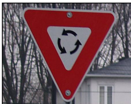
Figure 3.27 Panneau « Cédez le passage à un carrefour giratoire » en forme de triangle isocèle, giratoire du bout-de-l'île de Montréal (2006).
