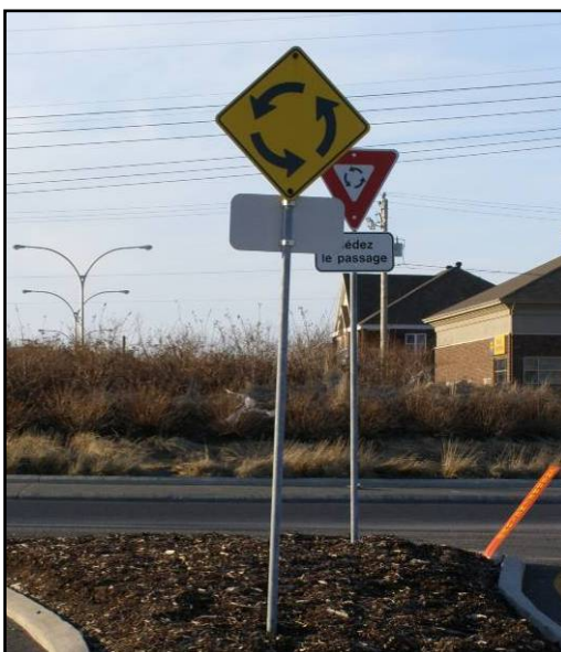
Figure 3.36 Mauvaise localisation de panneau « Intersection », giratoire de Chambly 2 (2008).
