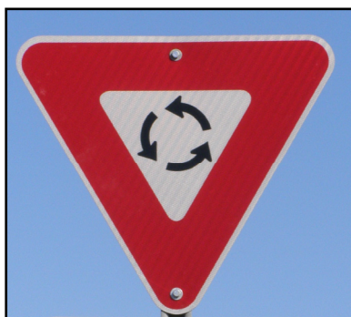
Figure 3.26 Panneau « Cédez le passage à un carrefour giratoire » en forme de triangle équilatéral, giratoire de Boucherville (2008).
