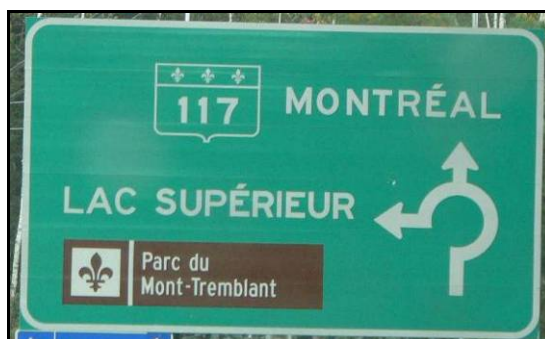
Figure-A XXIII-16 Signalisation d'équipements touristiques sur « Panneau schématique » 2, giratoire de Mont-Tremblant 1. Photographie : MTQ (2004)
