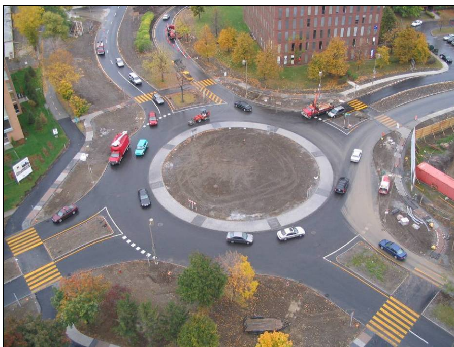
Figure 3.8 Chaussée annulaire de largeur uniforme, giratoire de l'Île-des-Sœurs 2. Photographie : MTQ (2004)
