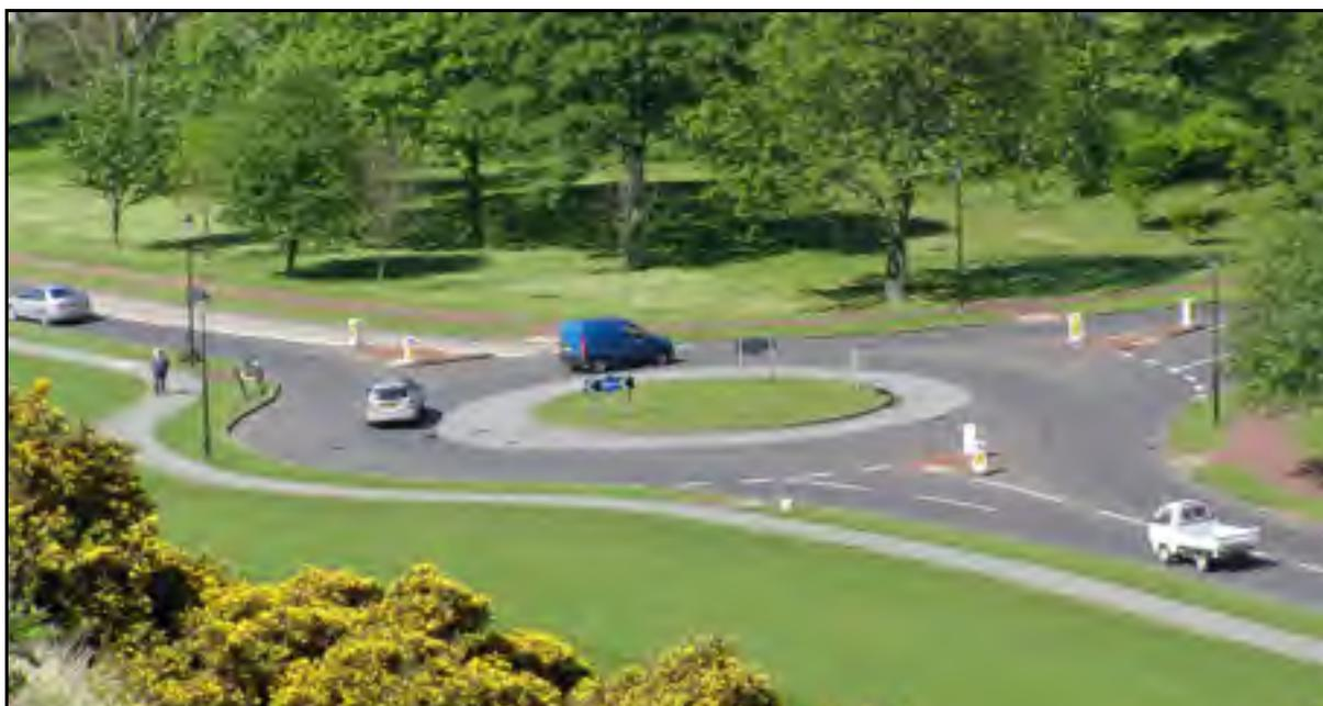
Figure 1.26 Exemple de chaussée annulaire d'un carrefour giratoire sans marquage à Édimbourg en Écosse (2008).
