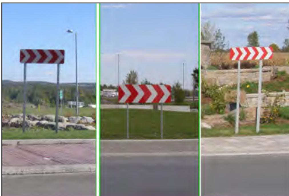
Figure 3.47 Non-uniformité de la hauteur des panneaux « Chevrons d'alignement dans un carrefour giratoire »<sup>19</sup>.
