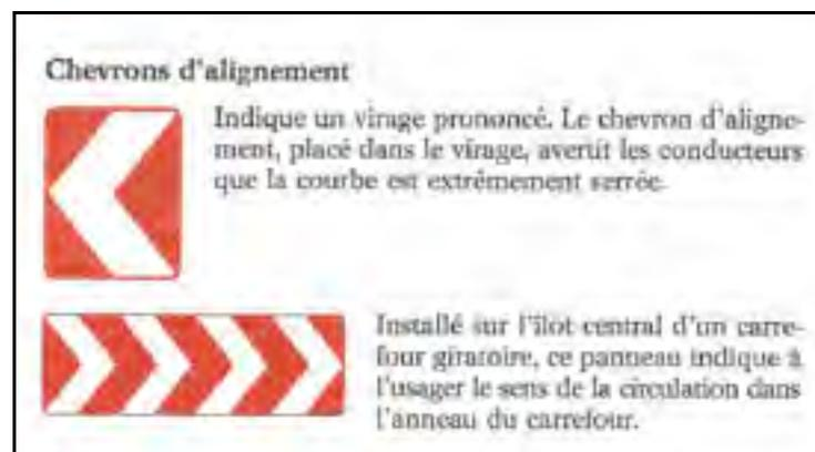
Figure-A XI-3 Extrait 2 du giratoire dans le Guide de la route : Signalisation de danger.
