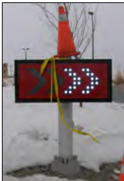
Figure 3.86 Panneau lumineux dysfonctionnel, giratoire du bout-de-l'île de Montréal (2008).
