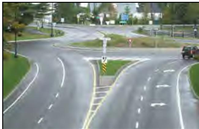
Figure-A XXV-2 Marquage de flèches de direction en approche 2, giratoire de Mont-Tremblant 1.
