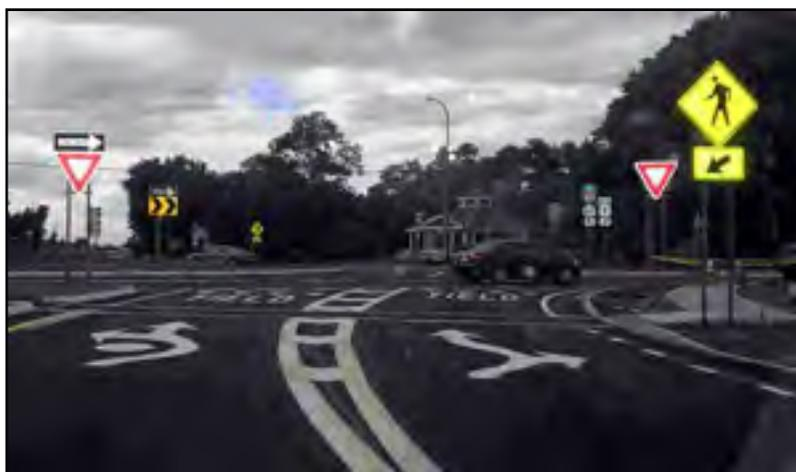
Figure 1.23 Exemple d'application du marquage de flèches de sélection de voies aux États-Unis.
