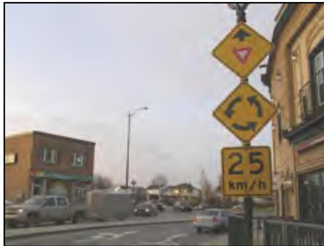
Figure 3.70 Deux panneaux de présignalisation sur un même poteau, giratoire de Gatineau 1 (2008).
