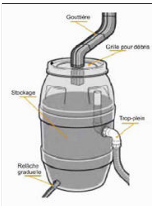
Figure 2.7 Baril pour le stockage Tirée du MDDEP (2011, p. 11-28)
