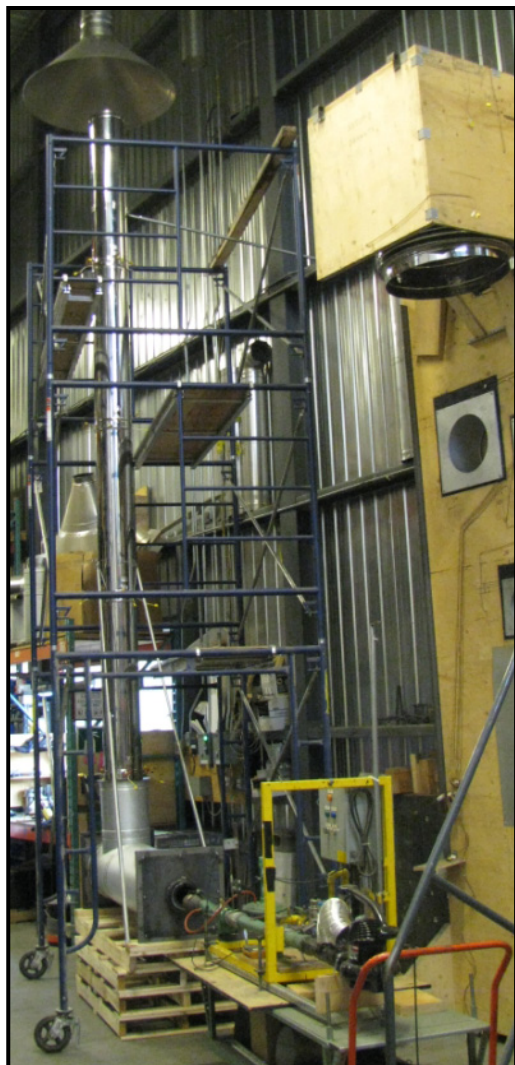
Assemblage complété du banc d'essai comprenant une cheminée uniquement.
