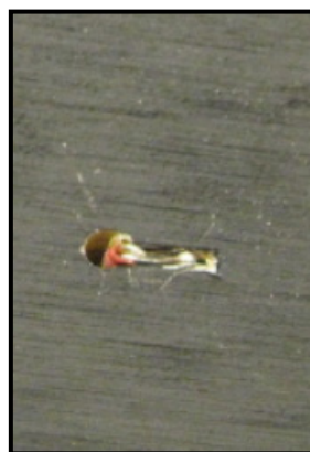
Thermocouple replié dans le contreplaqué de bois
