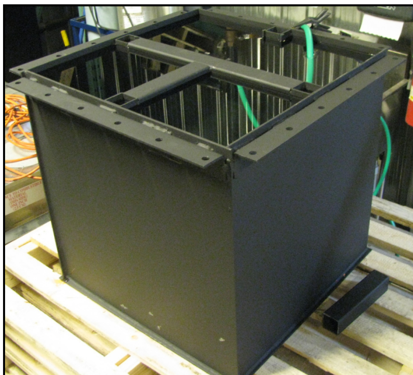
La boîte d'acier est remplie d'eau afin de détecter les fuites.
