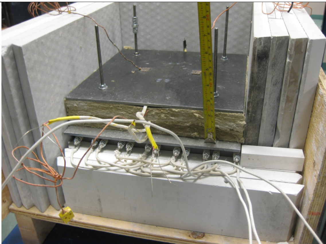
Circuit électrique de puissance connecté aux éléments chauffants et 2 épaisseurs de laine isolante 2 po comprimées à 2 po.
