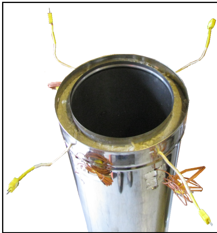
La cheminée Excel équipée avec 4 thermocouples moyenne température sur la paroi extérieure, et 4 thermocouples haute température sur l'extérieur de la paroi intérieure.
