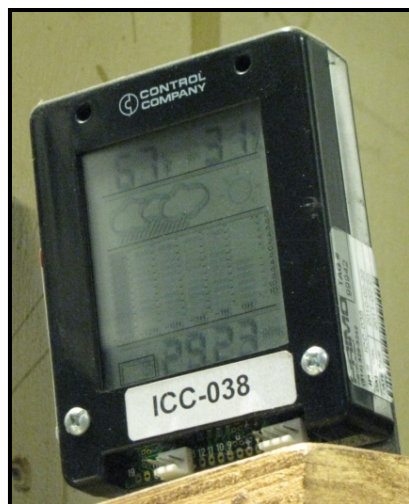
Capteur de pression atmosphérique, de pourcentage d'humidité et de température ambiante
