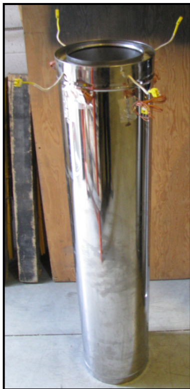
La cheminée Excel équipée avec 4 thermocouples moyenne température sur la paroi extérieure, et 4 thermocouples haute température sur l'extérieur de la paroi intérieure.
