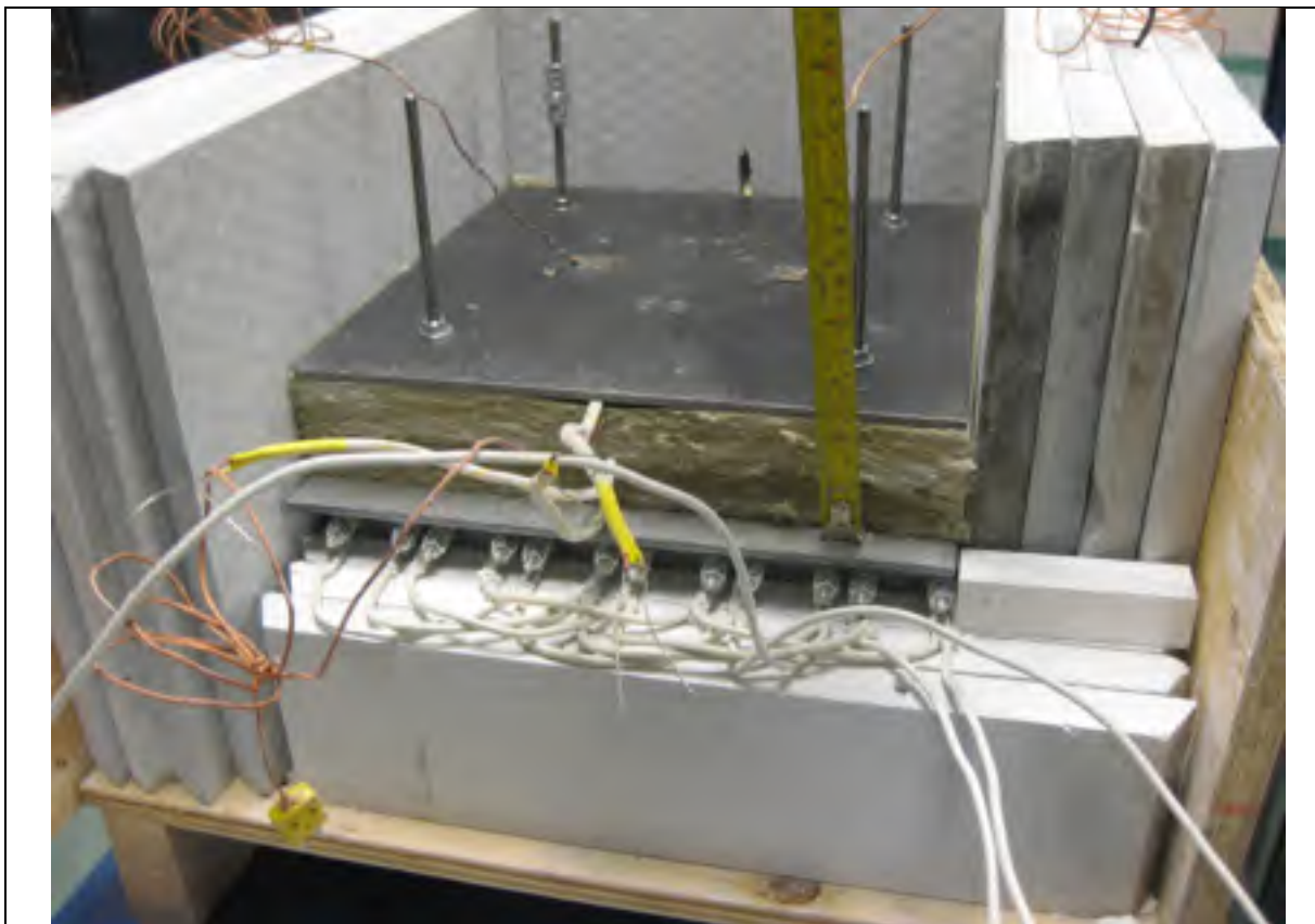
Circuit électrique de puissance connecté aux éléments chauffants et 2 épaisseurs de laine isolante 2 po comprimées à 2 po.
