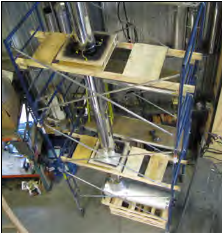
Assemblage des planchers avec la cheminée
