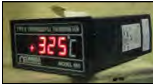
Lecteur de température (nécessaire au système d'acquisition secondaire)
