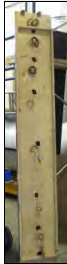
Mur arrière, thermocouples extérieurs
