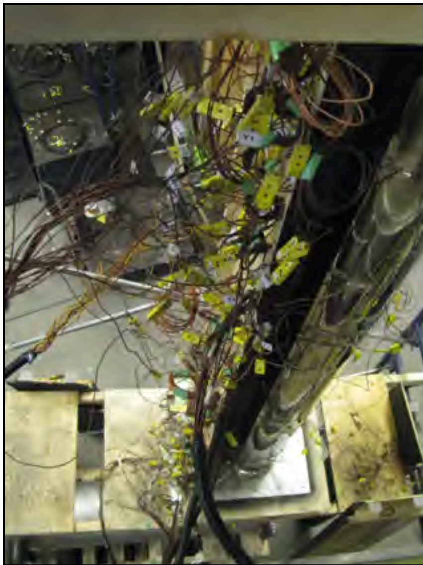
Thermocouples du mur avant connectés aux extensions reliées au système d'acquisition
