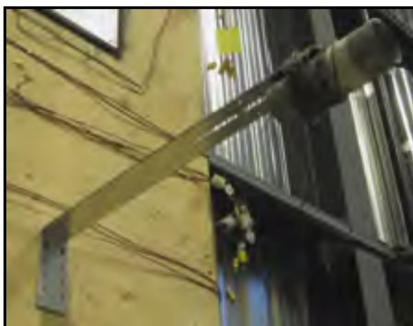
Thermocouple mesurant la température ambiante, relié au système d'acquisition
