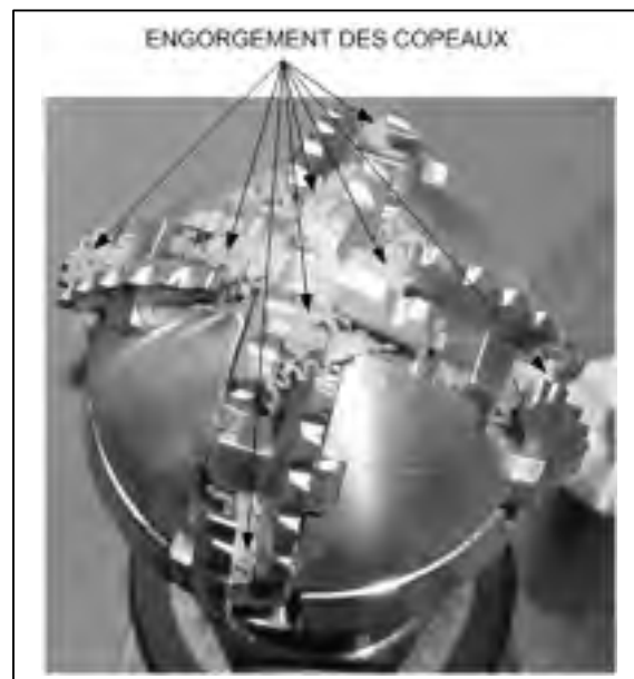
Figure 5.5 Engorgement des copeaux suite à un alésage avec l'ADV au diamètre de 52 mm
