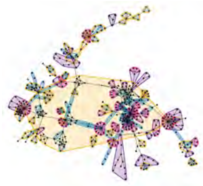
Figure 2.5 Sous-graphes pré-calculés par le prototype pour faciliter la saisie de différentes parties du graphe : chaînes (en bleu), arborescences (en mauve), bicomposantes (en orange), ensembles de nœuds ayant les mêmes voisins (en rose).
