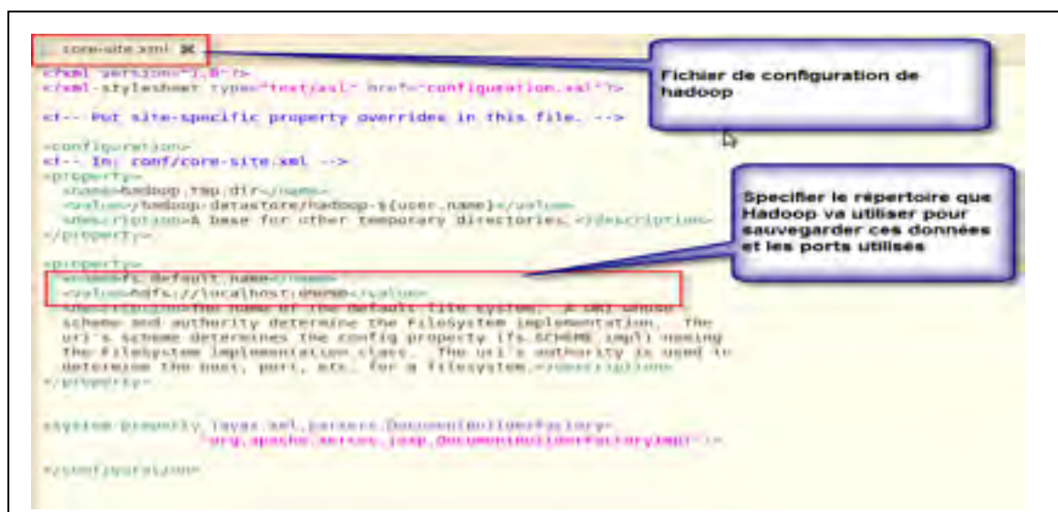
Figure III.2 Configuration du système du fichier de Hadoop
