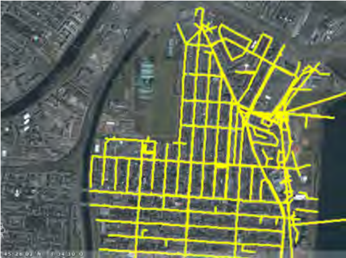
Figure 4.2 Réseau d'égout de Verdun
