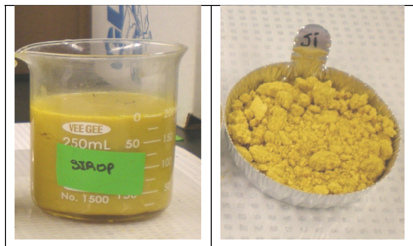
Figure 2.3 Sirop avant la lyophilisation à gauche et après la lyophilisation et le broyage à droite
