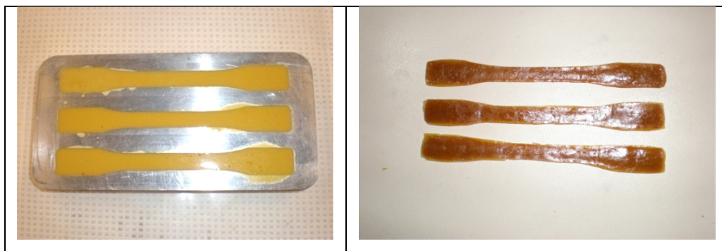
Figure 2.5 Résine bioplastique dans les moules ASTM de type I à gauche et éprouvettes séchées et démoulées à droite
